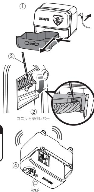
② ダストケース内部にある「ユニット操作レバー」を矢印の方向に回して、図のように詰まった芯が見える位置に動かします。
