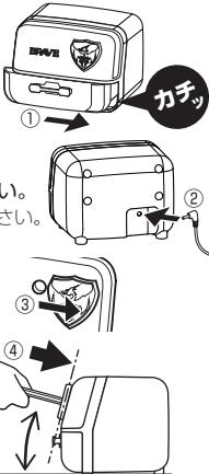
② 接続プラグを本体背面の DC IN 端子へ差し込み、
