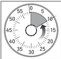
② 設定したい時間に時間表示フィルムの端を**反時計回り**で「10」に合わせてください。
