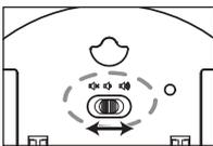
① 表面の音量設定スイッチの操作でアラームの音量を設定できます。
