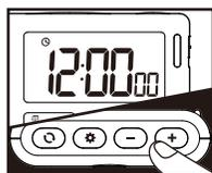
3. 時刻を入力します。+ ボタンまたは - ボタンを押して設定してください。ボタンを押し続けると早く進みます。「時」が点滅しているとき、\* ボタンを押して決定すると次の「分」の設定へ進みます。「分」が点滅しているとき、\* ボタンを押して決定すると次の「秒」の設定へ進みます。「秒」が点滅しているときには、+ ボタンと - ボタンのどちらを押しても、00秒になります。間違えて決定してしまった場合、C ボタンを押すと、前の設定へ戻れます。
