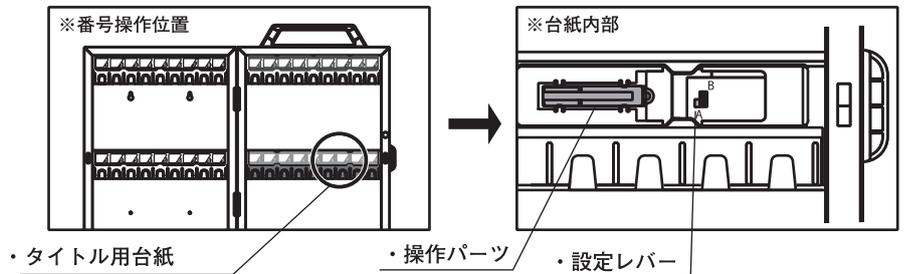
3. ダイヤルキー裏側にある設定レバーを「B」の位置に強く押し上げる
